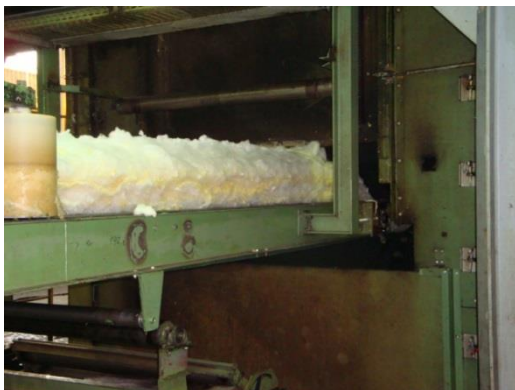
Vhod v trdilno komoro
